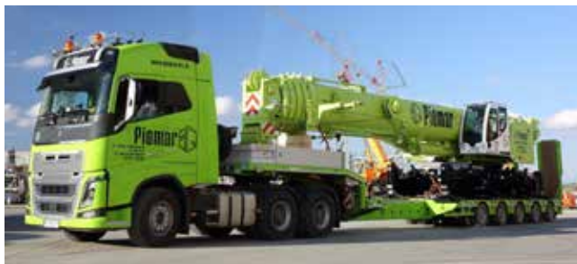
Кран на низкорамном трале Nootboom не превысит габарит по высоте, а сняв гусеницы, впишемся в 2,55 м по ширине
